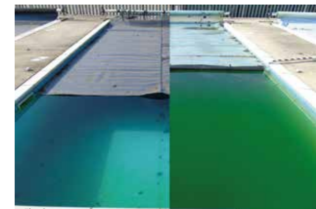
Fig. 3 L'image composite ci-dessus (Fig. 3) montre des piscines couvertes d'EnergyGuard™ Selective Transmission (la gauche) et d'une couverture transparente (droite) pendant la période hivernale.
