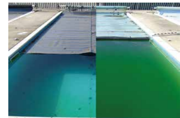
Das obige zusammengesetzte Bild (Fig. 3) zeigt Pools, die während der Winterperiode mit EnergyGuard™ Selective Transmission (L) und einer transparenten Abdeckung (R) bedeckt sind.
